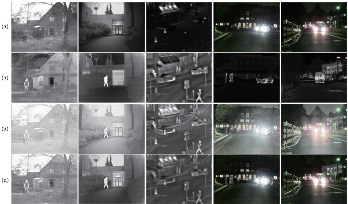
图 11 不同引导语句下的融合结果. (a) 可见光图像; (b) 红外图像; (c) 融合图像 1; (d) 融合图像 2
