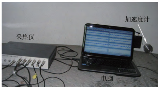
图 5 基于加速度计的振动测试系统
