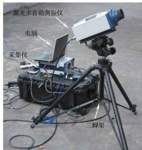
图4 激光多普勒测振仪系统
